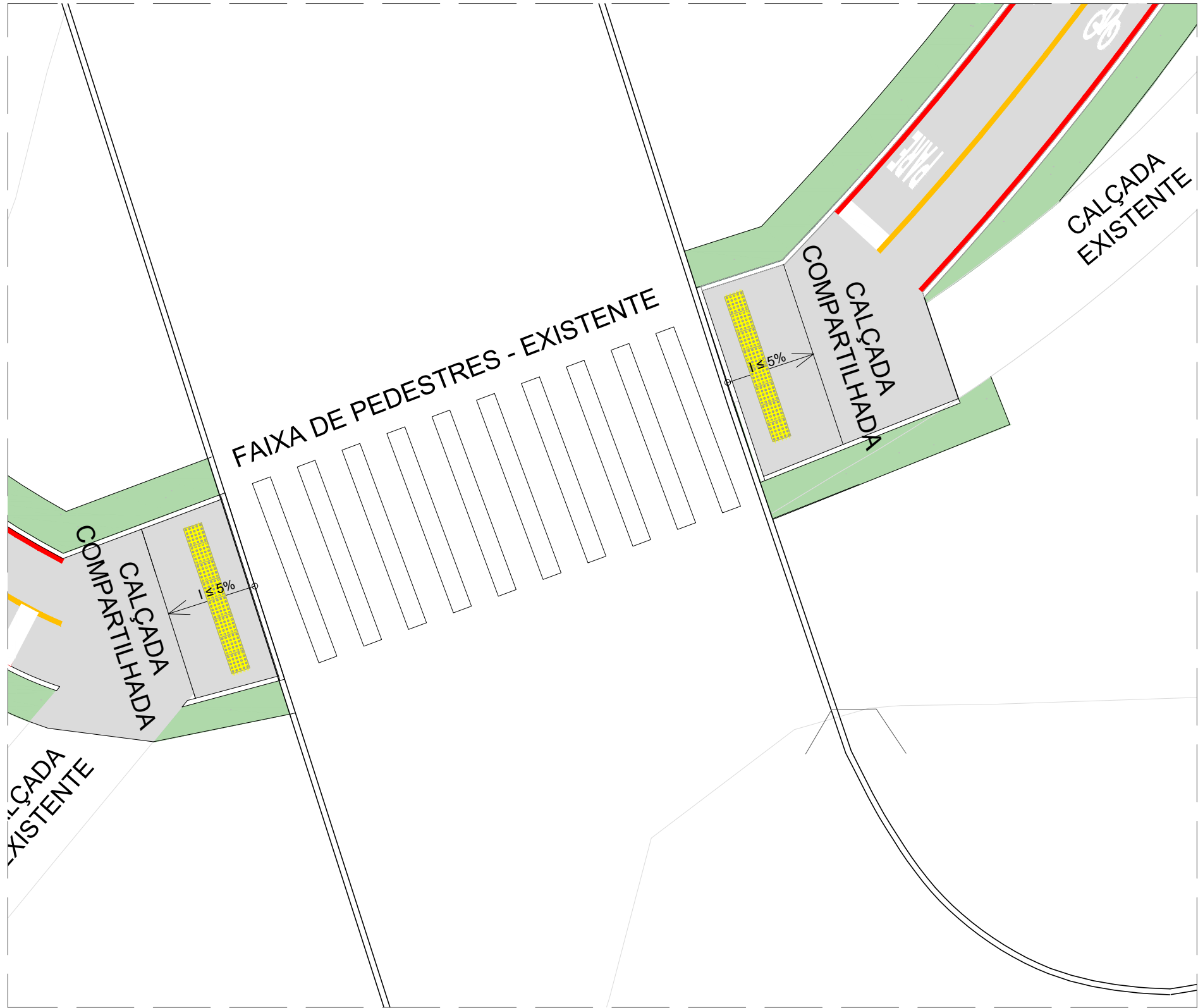
DETALHE 04 – FAIXA DE PEDESTRES EXISTENTE ESCALA 1/50
