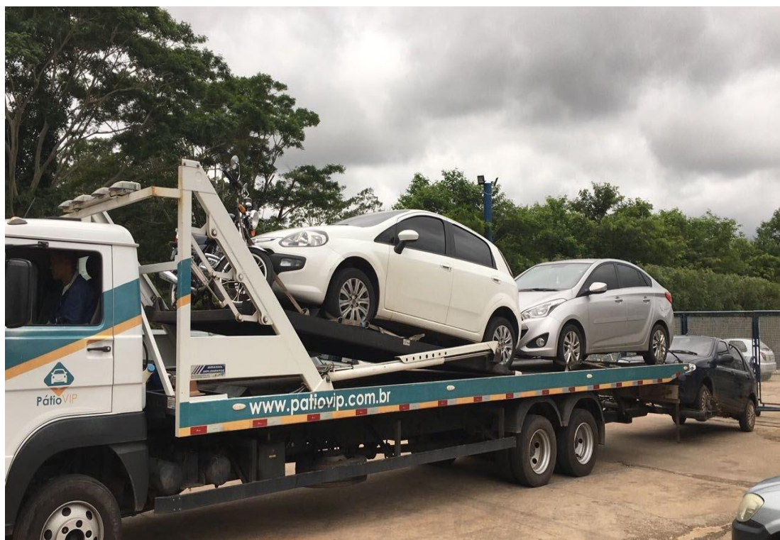
Figura 17: Foto exemplo de um guincho leve (Fonte: Elaboração própria)
