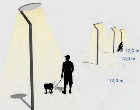
Poste City Soul gen2 LED Mini, temperatura 3.000K, suporte modelo Lyre, h=4,0m, marca Philips espaçados a cada 12m
