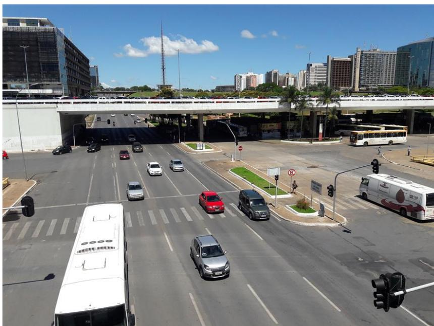
**Figura 35 - Ausência de Marcas Viárias no Acesso ao ERS e Áreas Internas do Terminal**
