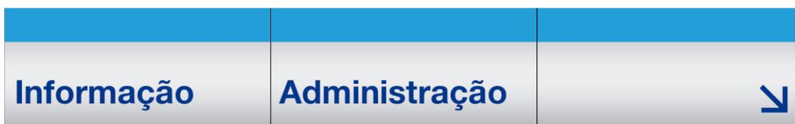
Figura 59. Placa com duas sinalizações distintas para a mesma direção.
