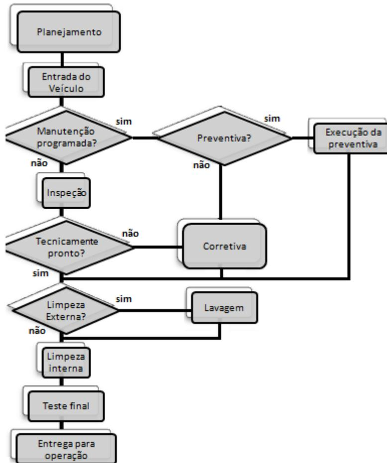
A sequência descrita deve ser seguida para garantir o bom funcionamento da complexo de manutenção, ou seja, os veículos que, ao terminarem a operação comercial diária e entrarem no pátio, passarão por um processo de limpeza e seguirão para o estacionamento.
