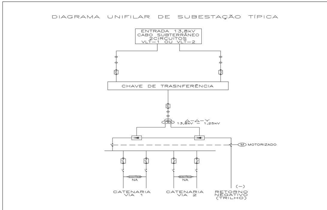
Porém, caso se decida aumentar ainda mais a confiabilidade do sistema de 13,8 kV, poderão ser instaladas chaves seccionadoras interligando os circuitos de 13,8 kV das SE's VLT-1 e VLT-2. Essas chaves deverão ser mecânica e eletricamente intertravadas com os disjuntores dos cubículos alimentadores, de forma que não haja condições de paralelismo dos circuitos de 13,8 kV. Estudos específicos deverão ser feitos para estabelecer as condições da possibilidade ora descrita, quando do projeto executivo.
