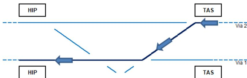
Após a prestação de serviço em HIP via 1, o trem segue pela rota sobre o AMV em normal até a TAS:
