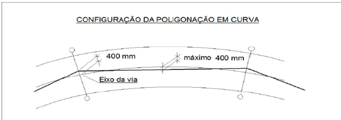
Figura 2: Configuração da Poligonação em trechos de curva
