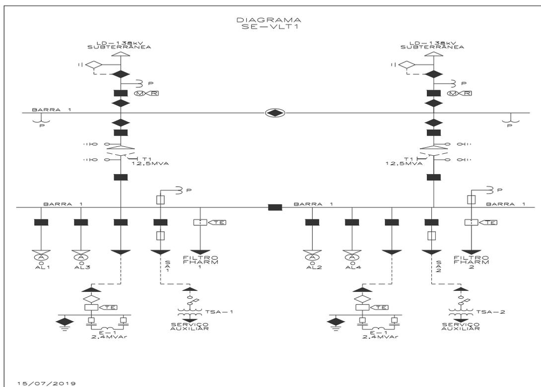
O barramento de 13,8 kV (cubículos), também terá contingência “n-1”, com 2 (duas) barras de 13,8 kV, interligadas por disjuntor instalado no cubículo de
