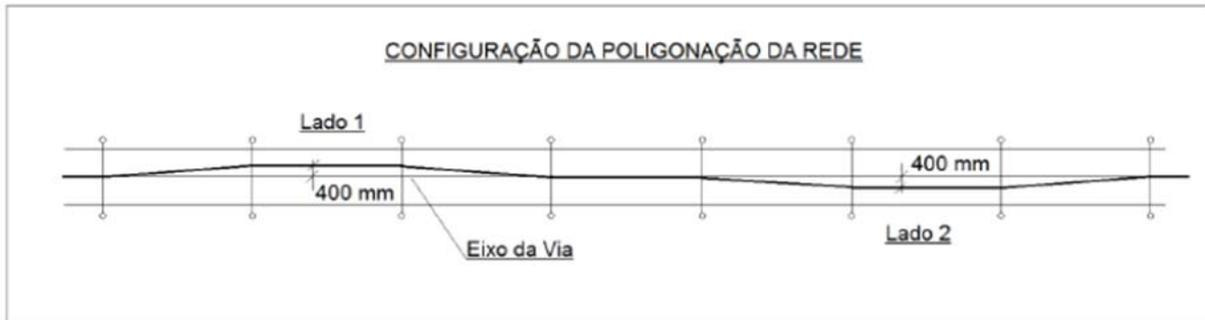
Figura 1: Configuração da Poligonação em trechos retos
