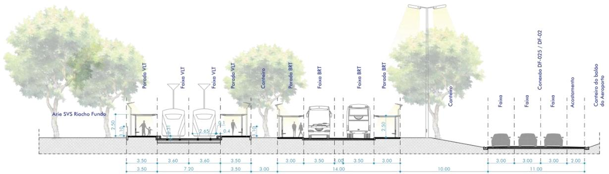
Figura 16 - Caixa da Via Trecho TAS - Aeroporto -Seção
